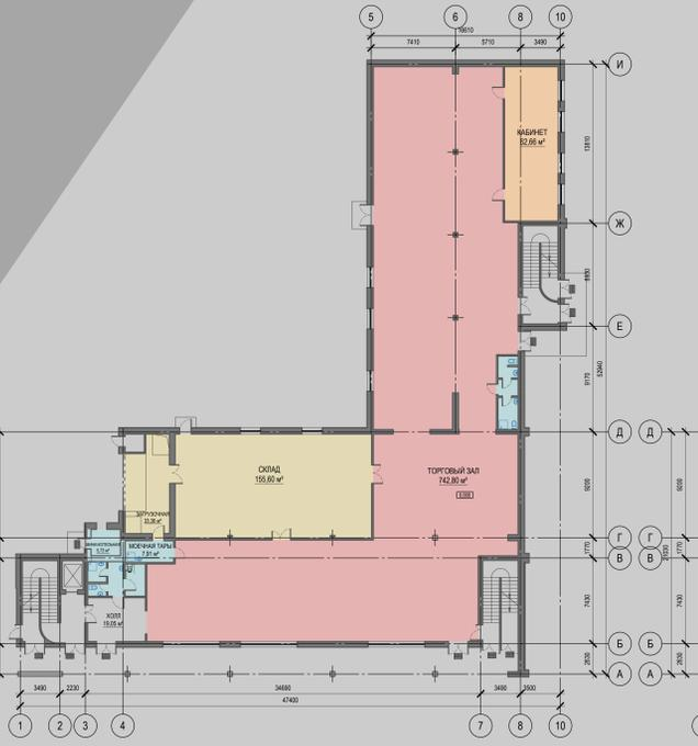
ПЛАН ВТОРОГО ЭТАЖА НА ОТМ. +4,200
