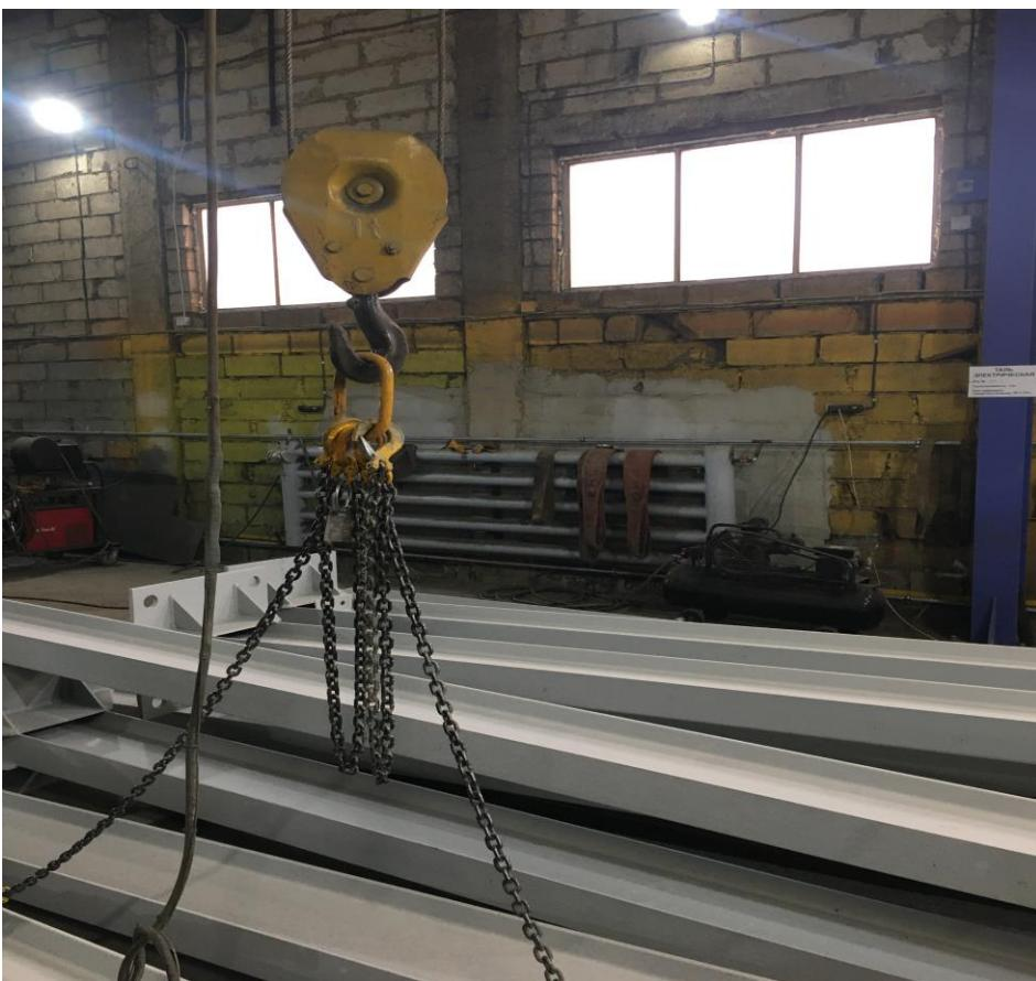
На электрической тали грузовой крюк не снабжен предохранительным замыкающим устройством, предотвращающим самопроизвольное выпадение грузозахватных элементов стропов, траверс и других грузозахватных средств
